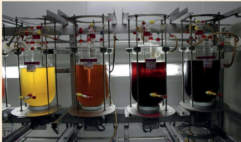
Figure 1 : Système de fermentation en conditions contrôlées de l'IFPC.
