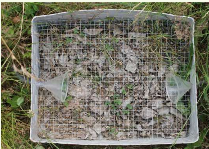
Piège "Marchi": Les spores issues d'un lit de feuilles sont aspirées (photo de gauche) et collectées sur un film plastique transparent enroulé autour d'un tambour rotatif gradué (photo de droite). (Photos IFPC - Maxime Baujean)
