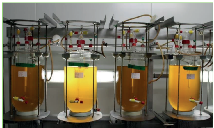
Fermentation des cidres en cuve de 16 l en chambre thermorégulée
