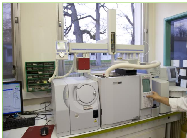
Chromatographe en phase gazeuse couplée à la spectrométrie de masse Identification et dosage des composés volatils (esters)
