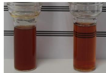
Comparaison de turbidité d'un pommeau avant et après microfiltration
