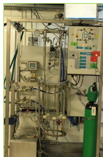
Micro-filtre tangential pilote
