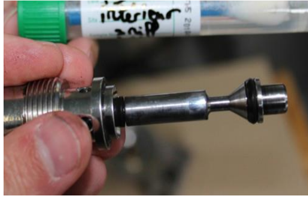
Système « snif » de mise à vide
