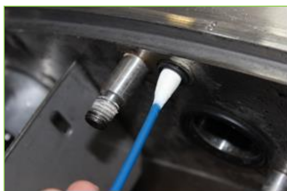
Écouvillonnage du conduit permettant la mise à vide (sous la cloche, bec de tirage enlevé)
