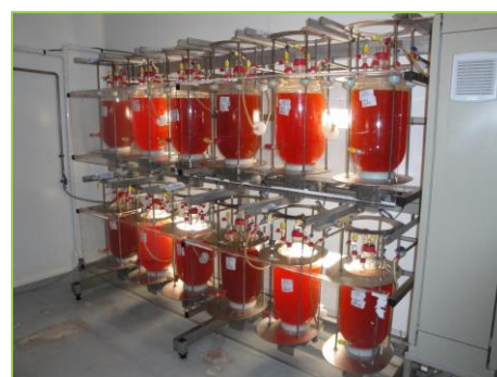
Rampe d'agitation automatisée de 12 fermenteurs de 15 L utilisée pour l'expérimentation
