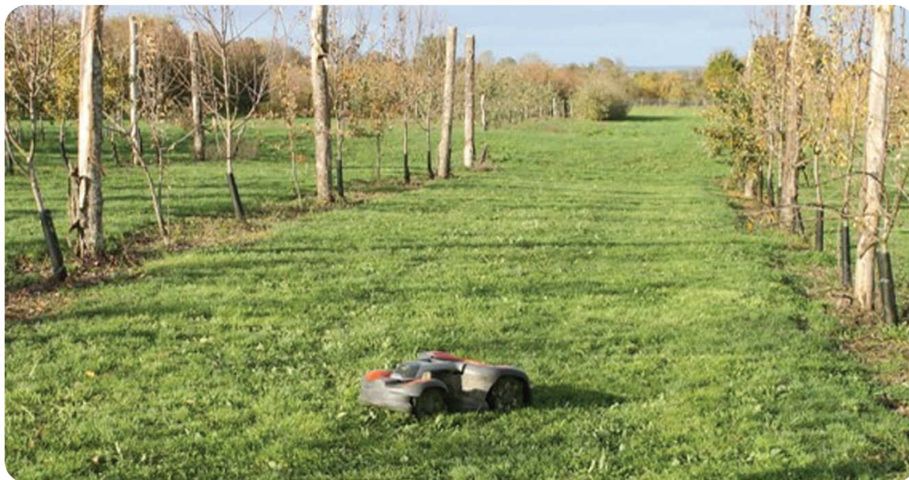
FIGURE 1 : Un robot de tonte autonome en fonctionnement dans une parcelle de la Station Cidricole de l'IFPC.
